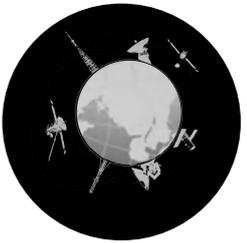
**Órbitas geosíncronas:** Órbita circular alrededor de la Tierra que se encuentra a 35,787 kilómetros de la superficie de nuestro planeta y en la que el periodo de traslación coincide con el periodo de rotación de la tierra (~24 horas).
