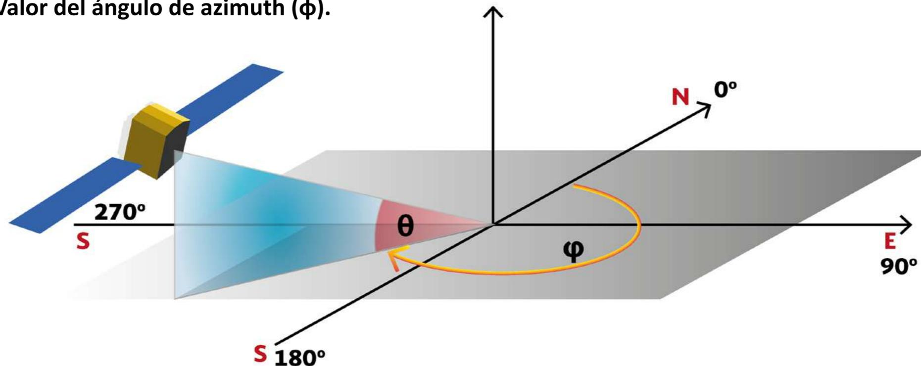
Para encontrar los ángulos de azimuth y elevación de la antena en la estación terrena, a partir de la longitud del satélite ( $LO_{sat}$ ), longitud de la estación terrena ( $LO_{et}$ ) y la latitud de la estación terrena ( $LA_{et}$ ) se tiene:
