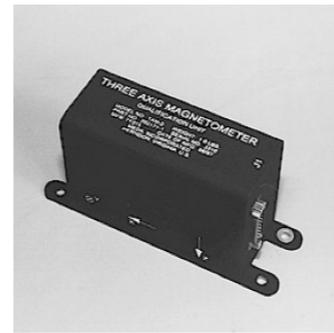
**Magnetómetros:** estos sensores tienen la capacidad de medir el componente del campo magnético en una dirección particular (vectoriales).
