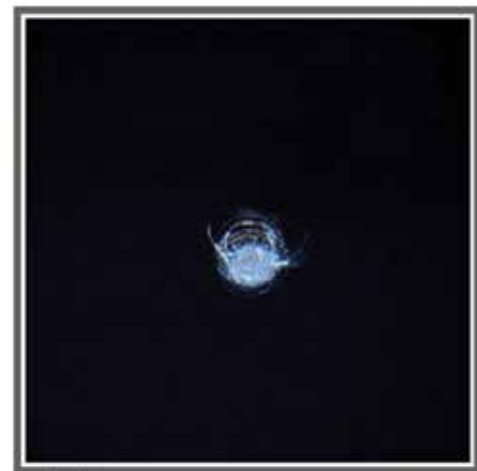
Figura 9. Daño ocasionado en una ventana de la Estación Espacial Internacional por basura espacial
